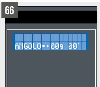
66 SHARK 332-1 / 382-1 / 452-1 SXI evo Visualizzazione angolo di taglio
