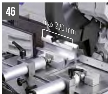
46 COBRA 352 NC 5.0 Morsa speciale riduzione sfrido
