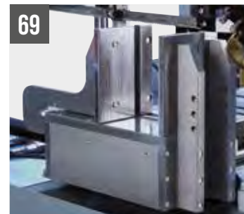
69 SHARK 230-1 NC HS 5.0 Morsa di taglio a doppio bloccaggio
