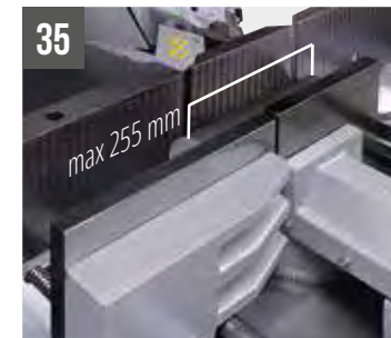
SHARK 332-1 NC 5.0 Morsa speciale riduzione sfrido
